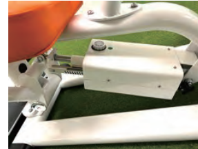
AIが動きを判断 可動域センサーユニット
